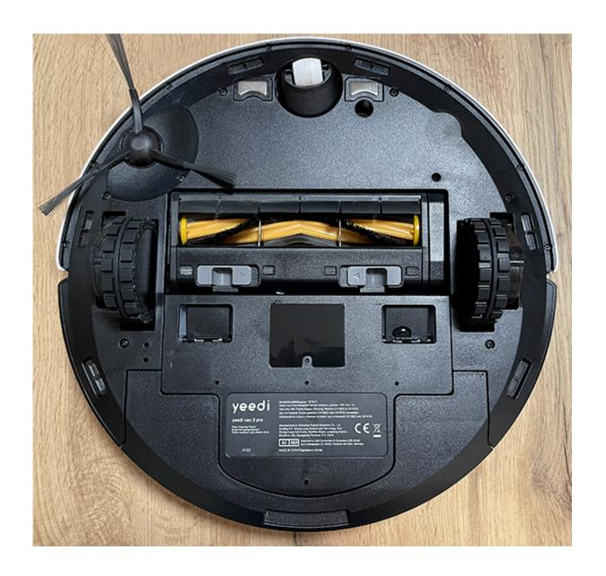
Ruotando il robot possiamo apprezzare la struttura di aspirazione, basata su una spazzola laterale a setole lunghe e morbide abbinata alla spazzola inferiore a contatto con il pavimento, attraverso a quale il motore di aspirazione rimuove lo sporco presente sul pavimento inviandolo al serbatoio di raccolta. Sui lati possiamo scorgere i sensori anticaduta, utili in presenza di scale nell'abitazione, oltre a quello per i tappeti.
