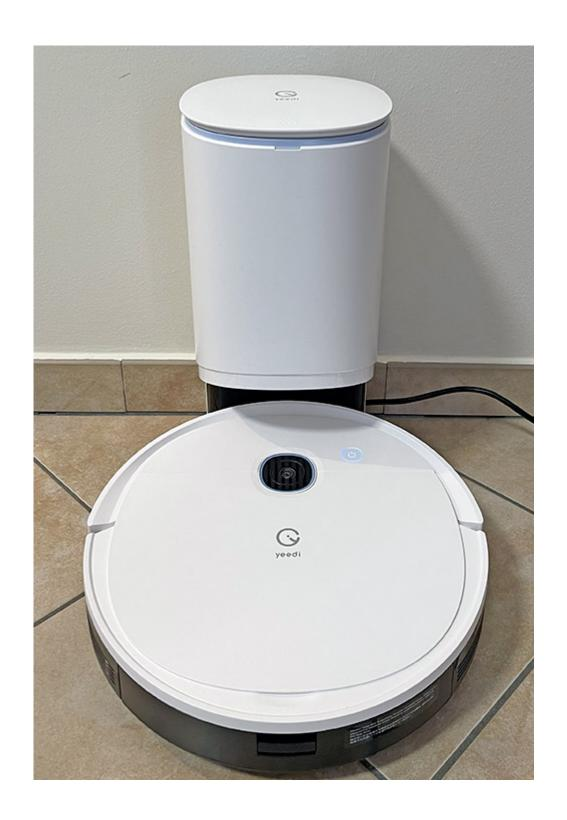
Il design esterno è speculare a quello degli altri prodotti yeedi: struttura circolare, una spazzola laterale per raccogliere lo sporco accumulato ai lati delle pareti e agli angoli, spazzola inferiore in gomma per la rimozione dello sporco presente sul pavimento e la sua aspirazione diretta nel serbatoio di raccolta. La base di autosvuotamento, accessorio opzionale, richiama in modo speculare quella di altri prodotti per l'aspirazione dei pavimenti: ricarica il robot una volta
