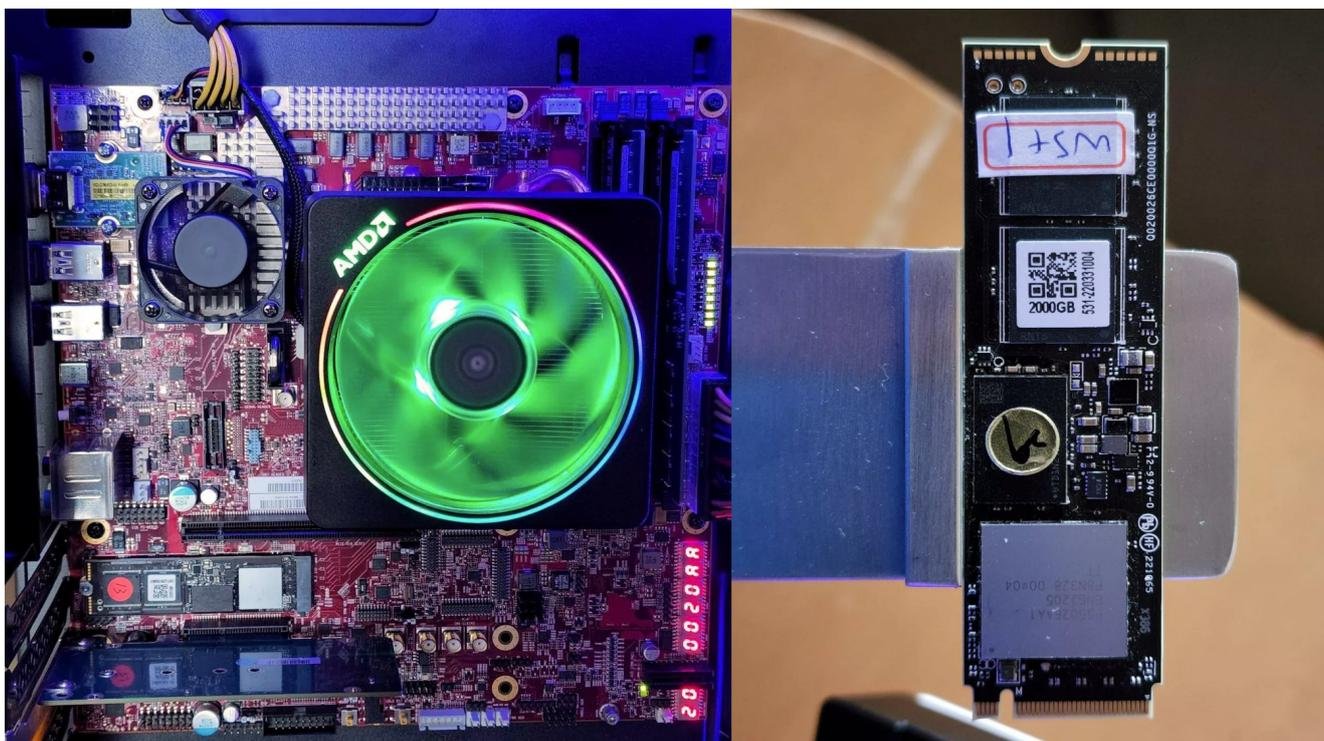
L'SSD, basato sulla nuova memoria **3D NAND TLC a 232 layer** [annunciata nei giorni scorsi da Micron](#) e da un controller Phison PS5026-E26, è stato installato su una piattaforma di riferimento di AMD, su cui era installato un processore identificato dal codice OPN "**100-000000593-20\_Y**". Grazie a precedenti indiscrezioni, quel codice è associabile al futuro **Ryzen 5 7600X, una CPU Zen 4 con 6 core e 12 thread**.
