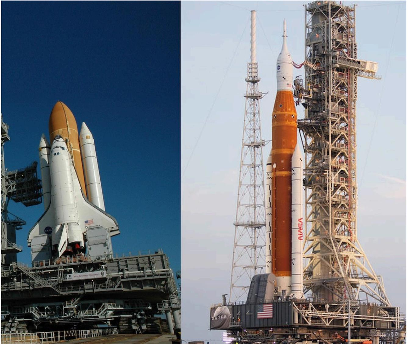
Lo Space Shuttle Discovery a confronto con SLS, i SRB sono i due cilindri bianchi ai lati del "Core Stage", il cilindro arancione centrale (NASA)
