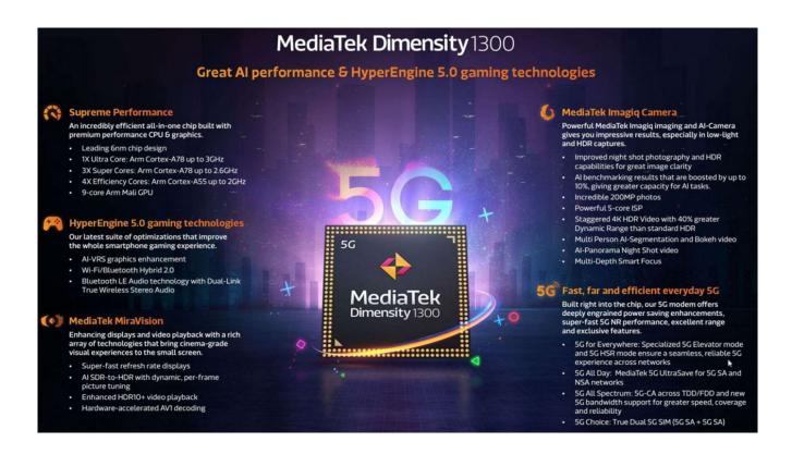
Il chip è basato sul **processo a 6 nm di TSMC**, ed è dotato di una CPU basata su architettura a otto core. Quattro di questi sono dei Cortex-A78, di cui uno in configurazione **Ultra con frequenza operativa massima di 3GHz**, e gli altri tre in configurazione Super capaci di raggiungere i 2,6GHz. Abbiamo infine quattro core a massima efficienza, basati sui core Cortex-A55 di ARM con capacità di raggiungere i 2GHz. Per la parte grafica ci sarà una GPU ARM Mali-G77 MC9, con 9 core dedicati.
