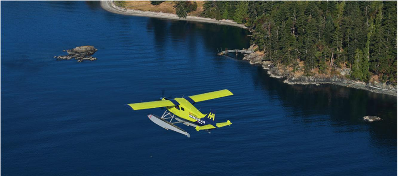
Il volo, **di circa 72 km**, e della durata di 24 minuti, si è svolto perfettamente e senza intoppi, e l'eBeaver aveva ancora **una buona riserva di energia** quando è atterrato. Il test ha dimostrato la fattibilità della conversione, anche grazie al **motore magni560**, con ben 560 kW di potenza. Si proseguirà ora con il perfezionamento del lavoro svolto, così da arrivare alla certificazione commerciale della FAA e di Transport Canada.
