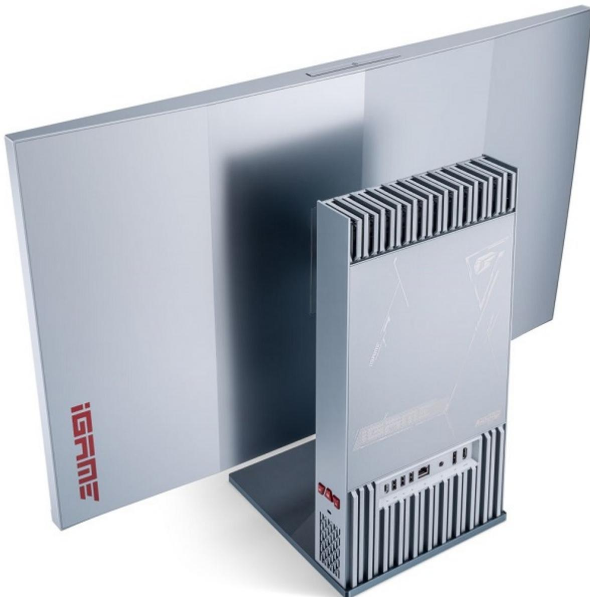
Dal punto di vista della connettività, COLORFUL ha dotato il G-ONE delle ultime tecnologie di connessione come il nuovo **Wi-Fi 6E** e non manca una porta **RJ45 2,5G** per connettere il computer alla rete via cavo, così da ottenere la minor latenza possibile. Le porte USB includono anche una **Type-C** e non mancano due uscite aggiuntive, una **HDMI 2.0** e l'altra **DisplayPort**, per realizzare configurazioni a tre monitor.
