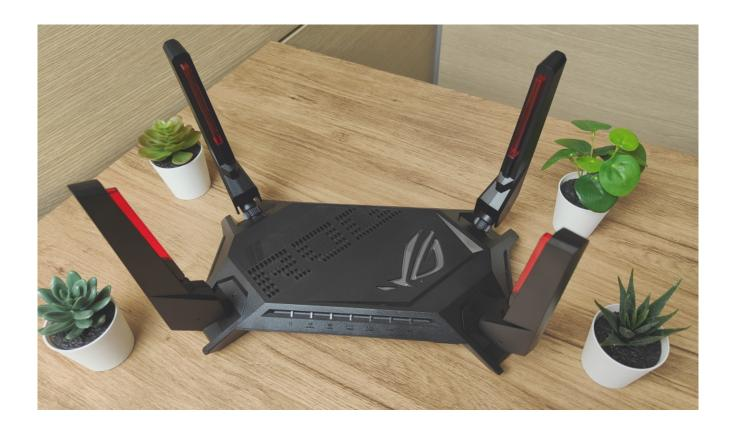
L'aggregazione LAN, invece, unisce due porte LAN da 1 Gbps per creare una connessione LAN da 2 Gbps, che è ottima per fornire larghezza di banda extra a dispositivi di rete impegnativi come un NAS compatibile o un PC desktop. Per offrire le prestazioni necessarie a garantire il corretto funzionamento
