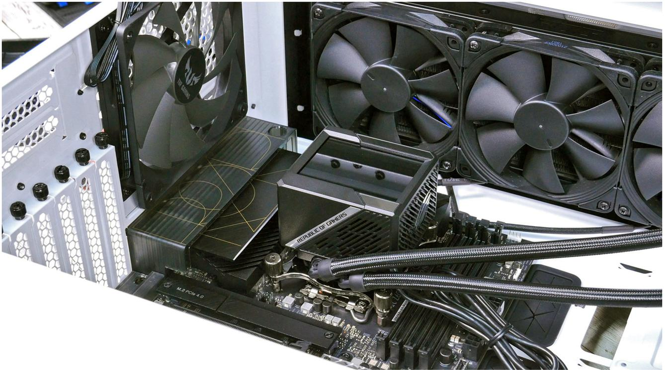
L'installazione dell'ASUS ROG Ryujin II 360 è semplice dal punto di vista tecnico, basta seguire le istruzioni a corredo, apporre la placca posteriore dietro la scheda madre, i fermi e posizionare la testa del dissipatore sul processore: ah, dimenticavamo, il dissipatore presenta un bollino di pasta termica preapplicata, a voi la scelta se ricorrere a una pasta termica di terze parti da applicare sulla CPU in posizione centrale prima di metterci sopra il dissipatore.
