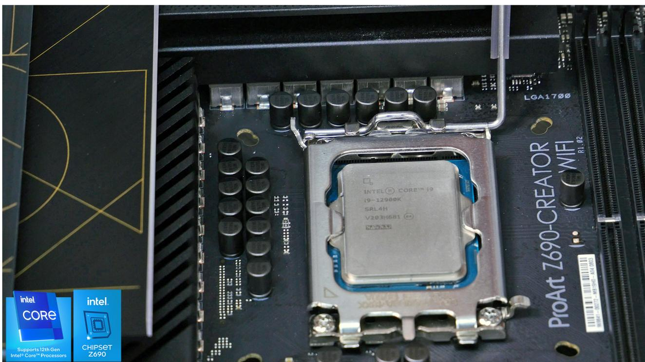
L'installazione del processore richiede di rimuovere il meccanismo di fermo, alzare lo sportello e inserire la CPU nel verso giusto (un triangolino dorato in un angolo della CPU aiuta a capire come posizionarla). Una volta fatto, e vi consigliamo di farlo con il case in orizzontale in modo da facilitare il posizionamento del microprocessore, chiudete lo sportello e agganciate il fermo.
